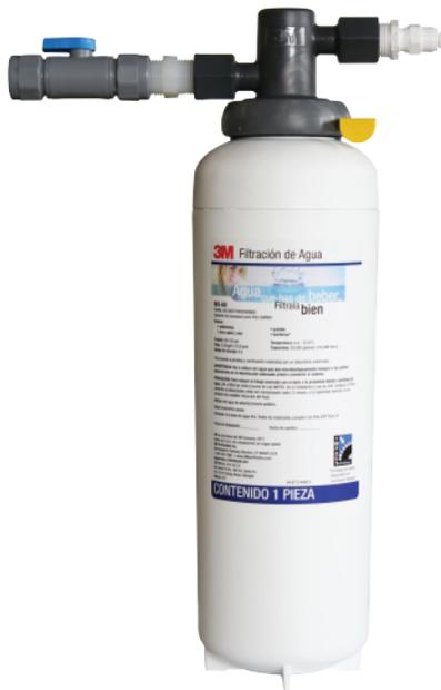
El sistema de filtración de agua DWMX1 de 3M Purification es un cartucho sencillo que ayuda a mejorar el sabor, la apariencia y consistencia de las bebidas además de hacerla microbiológicamente segura con flujos de hasta 3.34 gpm (12 lpm). Tiene una capacidad hasta 35,000 galones (132,489 litros). Certificado por la COFEPRIS en cumplimiento de la NOM 244 SSA.
