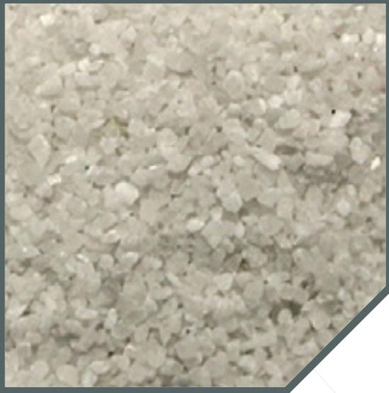
Corosex es un medio formado con partículas rígidas de óxido de magnesio, adaptadas para su uso como material filtrante, cuyo propósito es neutralizar la acidez por medio del incremento de pH.
