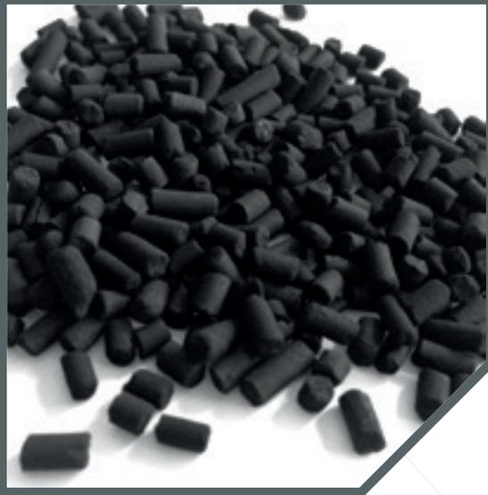
Carvacid Pelet es un carbón activado con capacidad de adsorción, tanto de vapores orgánicos como de gases ácidos. Se fabrica mediante la impregnación parcial en medio alcalino de un carbón mineral peletizado con una porosidad altamente desarrollada.
